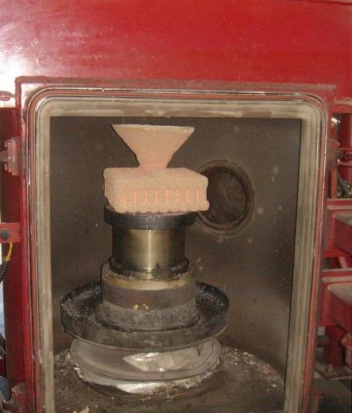
A **Fundição à vácuo** é utilizada para produção de ligas especiais que reagem com o ar. Estas ligas produzem peças resistentes à corrosão e a altas temperaturas. Por exemplo, super ligas a base de cobalto, MONEL, INCONEL, e HASTELOY.
