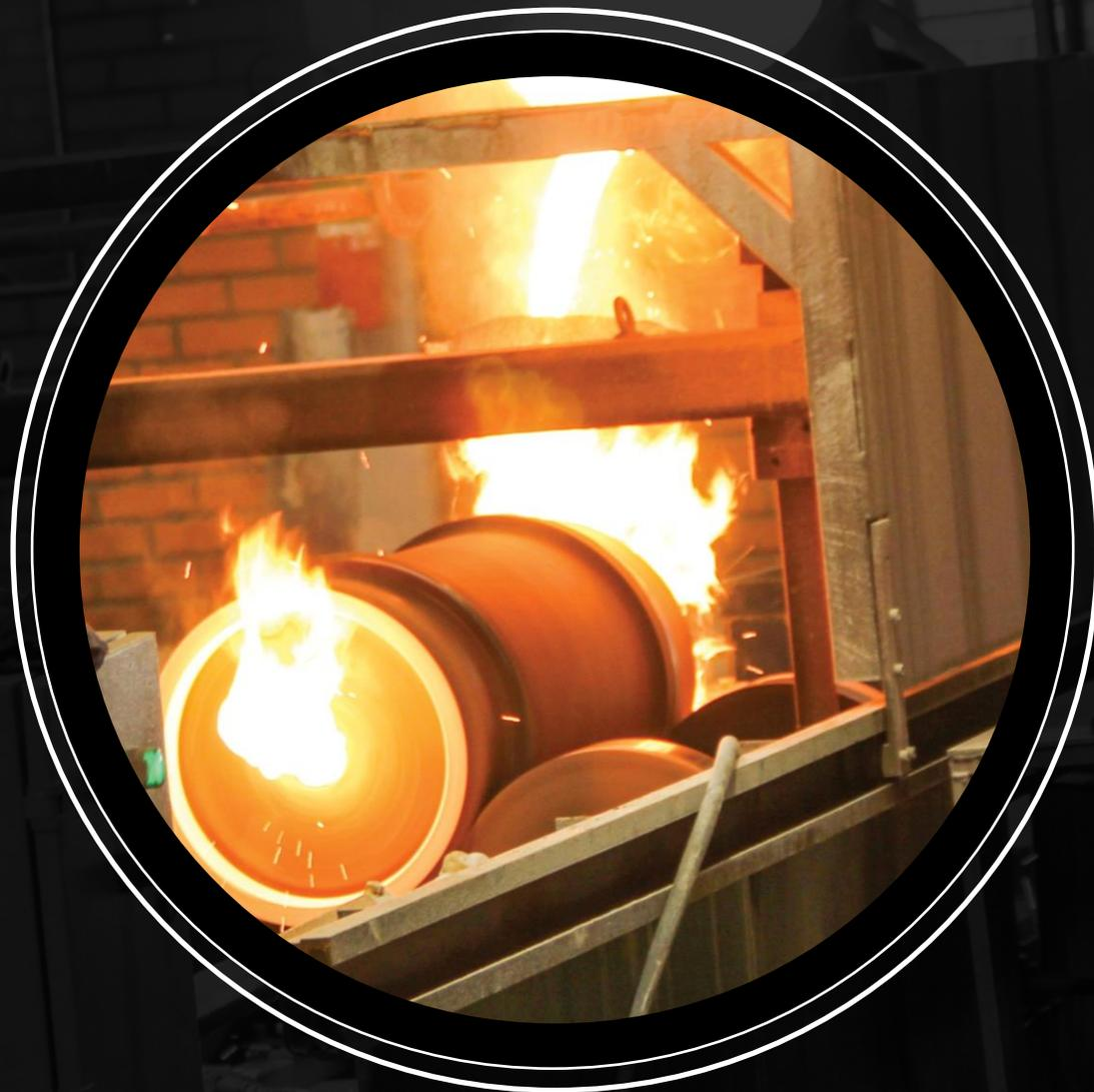
A **Fundição Centrífuga Micromazza**, produz materiais fundidos em alta liga, resistentes ao calor, à abrasão a quente e Linha de Zincagem, com a utilização dos mais sofisticados processos de fundição. A Fundição pode ser realizada utilizando Ligas de Aço Carbono, Inoxidáveis, Duplex, Ligas Refratárias (Aço de Alto Cromo/Níquel, resistente a altas temperaturas) e Ligas Especiais.
