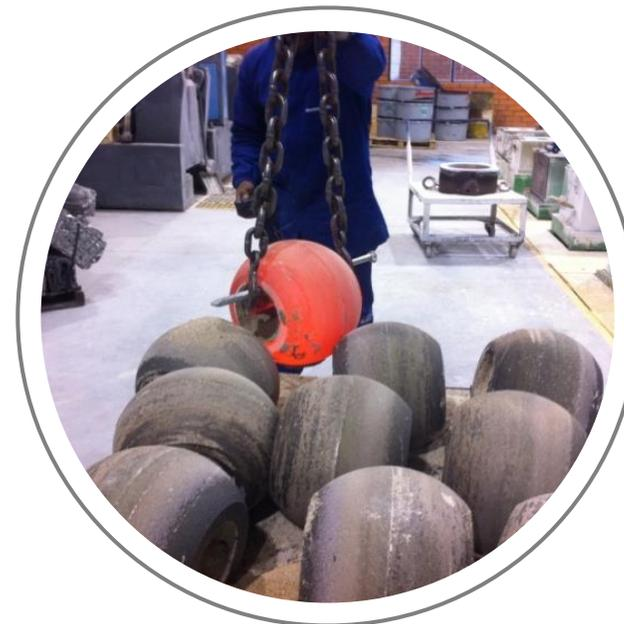
Centrífuga Vertical: Esferas de 4" (12 kg) até 20" (1000 kg); Buchas e anéis com diâmetro de 100 mm à 1500 mm, e comprimento de 100 mm à 700 mm.
