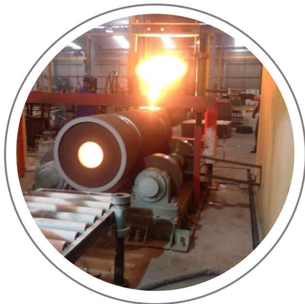
Centrifugação Horizontal, para Tubos, com diâmetro externo de 140 mm à 900 mm, comprimento de 100 mm à 2500 mm. Peso: de 10 kg a 800 kg.
