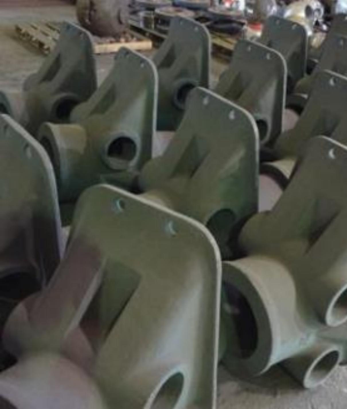
A capacidade da **Fundição de Areia** chega a 200 toneladas / mês em diversas ligas de aços tendo como especialidade a fundição de peças para válvulas, bombas, peças para guindastes, hidrelétricas e máquinas agrícolas.
