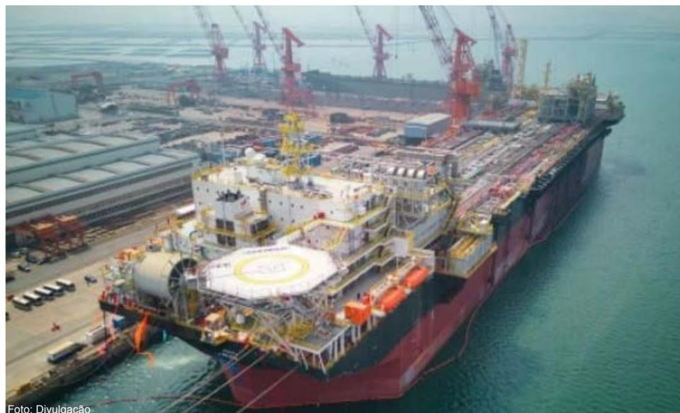
A Dalian Shipbuilding (DSIC), parte da China State Shipbuilding Corporation (CSSC), entregou uma embarcação flutuante de armazenamento e descarga (FPSO) com destino a um campo operado pela Equinor no Brasil.
