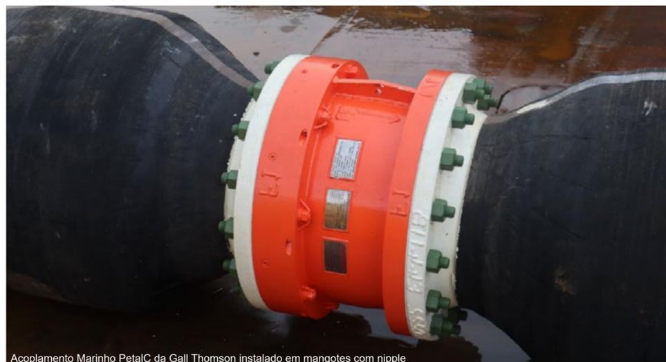
Acoplamento Marinho PetalC da Gall Thomson instalado em mangotes com nipple
